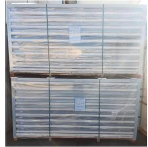
*Exemple sur les panneaux sandwich de l'entreprise COUGNAUD : suppression du film plastique bleu, du scotch et de douffline (non recyclables) au profit d'un seul film transparent recyclable.*
